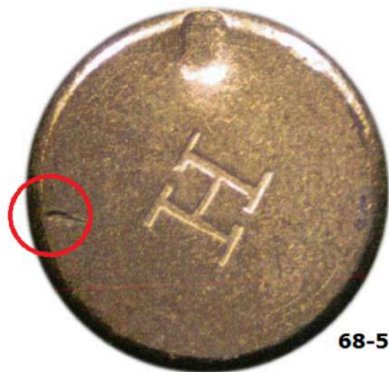
Bossolo nel fascicolo Mele. Cerchiato in rosso, il "graffio" dell'espulsore evidente a ore 9
