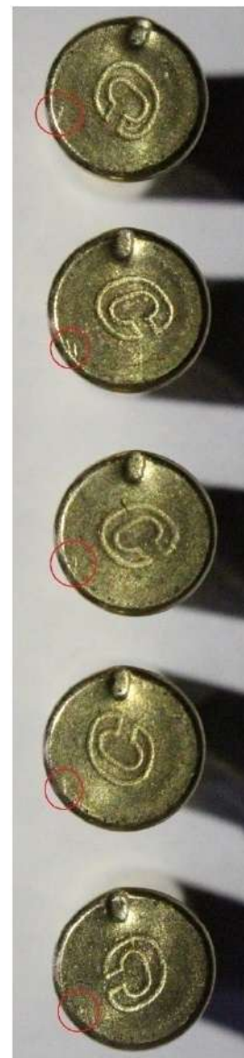
Bossoli espulsi da una Beretta 76 calibro .22. Cerchiato in rosso, il segno dell'espulsore
