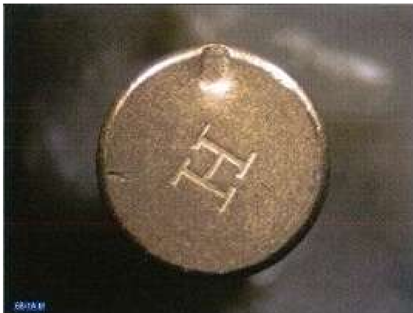
Bossolo trovato nel fascicolo Mele fatta vedere agli esperti balistici intervistati. Il "graffio" dell'espulsore è a ore 9. Si nota anche a occhio nudo
